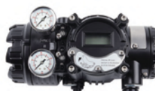
Электро-пневматический интеллектуальный позиционер во взрывозащите (HART, PROFIBUS...)
